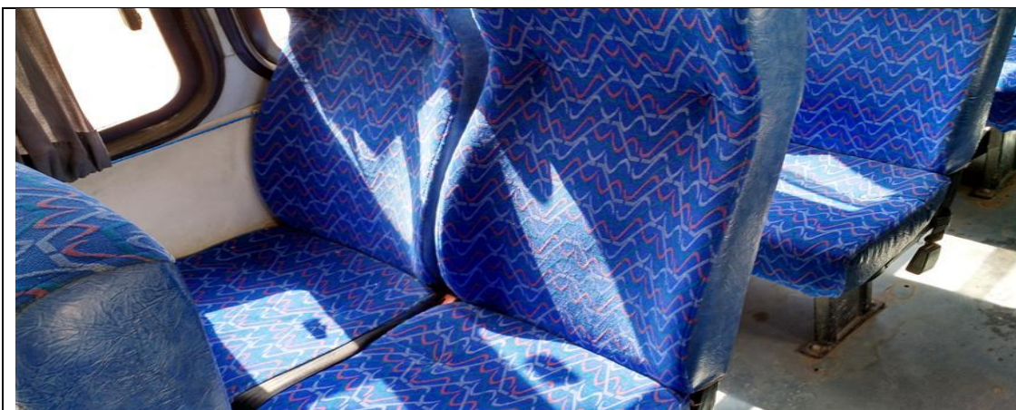
Foto 9: Veículo de placa MYJ-0223, assentos sem cintos de segurança, Chã Grande (PE), 8 de julho de 2015.
