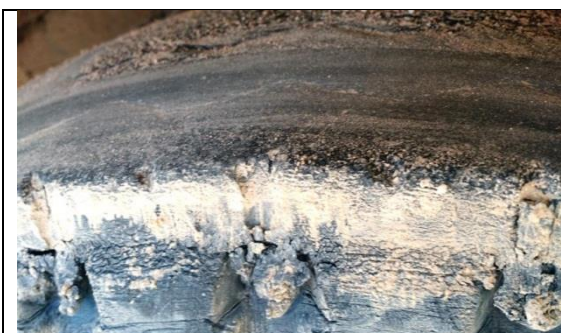
Foto 13: Veículo de placa MNO-9200, pneu liso (“careca”) deteriorado, Chã Grande (PE), 8 de julho de 2015.
