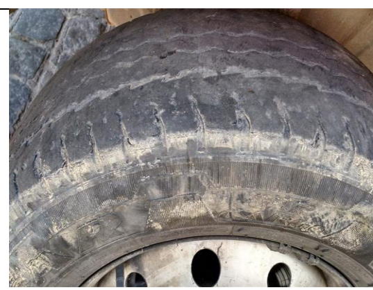
Foto 4: Veículo de placa LKM-1973, pneu liso (“careca”), deteriorado, Chã Grande (PE), 8 de julho de 2015.
